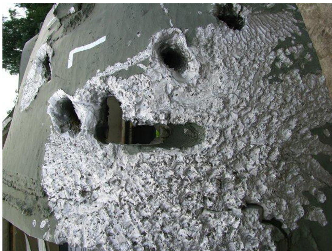
Башня танка после попадания кумулятивных снарядов
