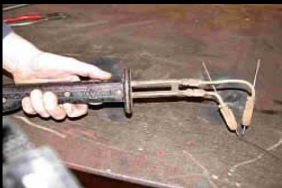
Аппарат для сварки атомарным водородом
