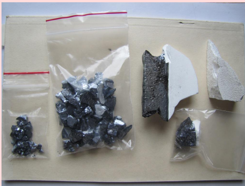
Кремний и куски кварцевого тигля (одноразовый тигель из спеченного кварца, используется для плавки кремния)
