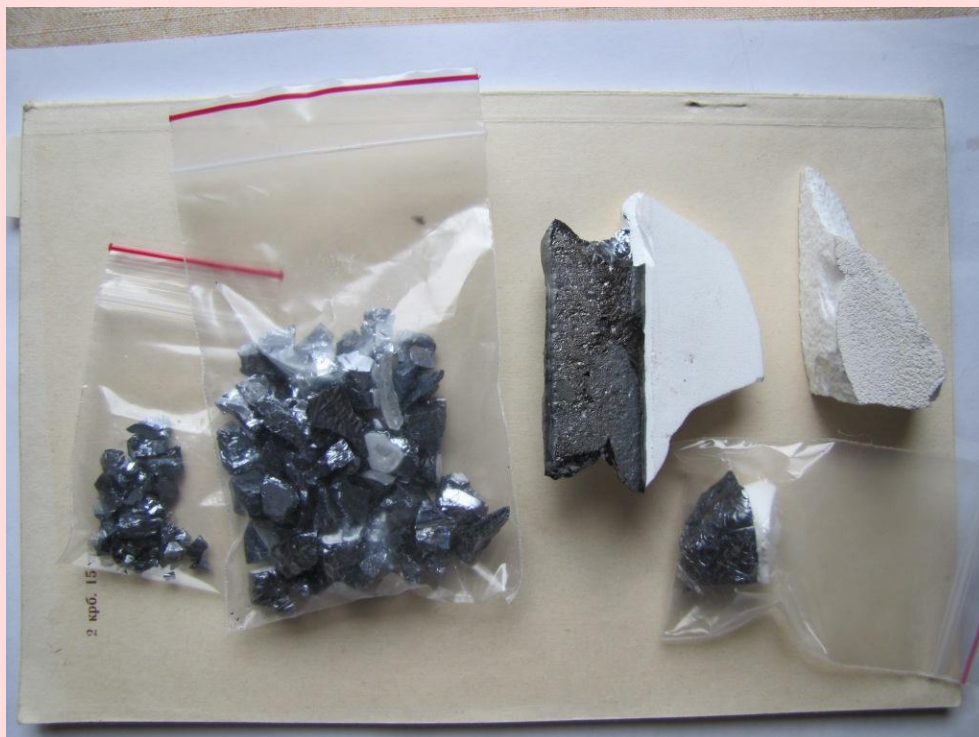
Кремний и куски кварцевого тигля (одноразовый тигель из спеченного кварца, используется для плавки кремния)
