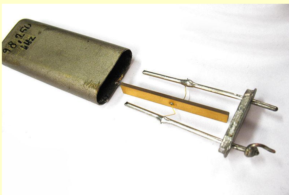
Кварцевый резонатор извлечен из корпуса. Поверхность пластинки покрыта позолотой
